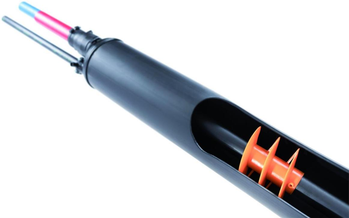
Bild 4 o Der Rohrmantel als Tauscherfläche hat über den gesamten Ring einen gleichmäßigen Abstand zum wärmeleitenden Erdreich. Bei Doppel-U-Sonden besteht zum Teil Kurzschluss zwischen den Strängen.
